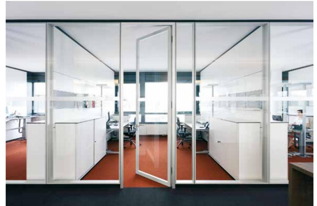
Transparenz und Flächenbündigkeit sind Ausdruck aktueller Architektur. In fecostruct finden sie ihre bauliche Entsprechung. Eindrucksvoll ist die Verklebung der rahmenlos flächenbündigen Verglasung auf den verdeckt liegenden Aluminium-Glasrahmen mit nur 20 mm Breite. Das Ergebnis sind vollkommen plane Glaswände, die begeistern und dabei so selbstverständlich erscheinen.
